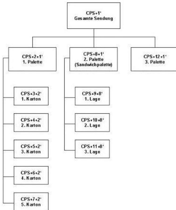
Mit dem CPS-Segment sollten alle Versandeinheiten in der Hierarchie beschrieben werden, die mit einer Packstückidentifikation (NVE) versehen sind.
